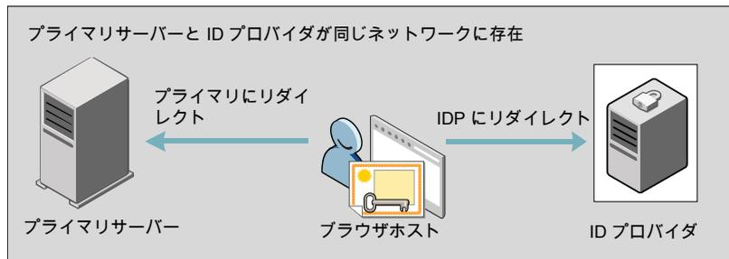
図 13-4 構成の例: プライベートネットワークのプライマリサーバーとパブリックネットワークの ID プロバイダ
