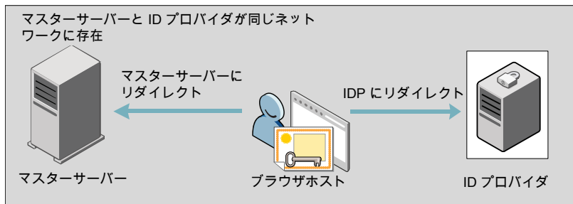
図 12-3 構成の例: 同じネットワークのマスターサーバーと ID プロバイダ
