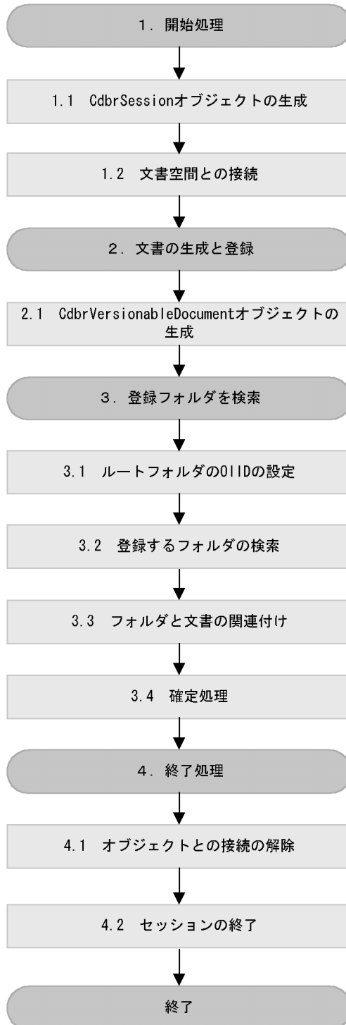
図 A-2 特定のフォルダに文書を新規に登録するシーケンス
