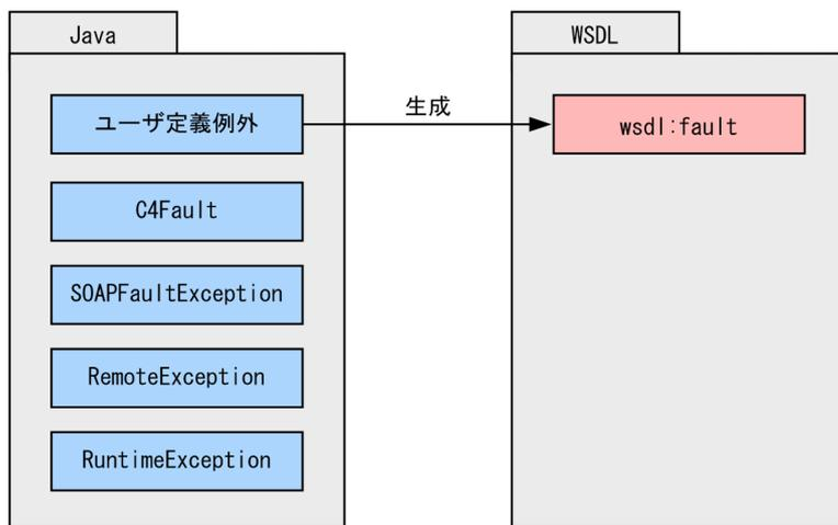
Java 例外のうち、ユーザ定義例外が WSDL Fault (wsdl:fault 要素) にマッピングされます。その他の Java 例外については、マッピングされません。
