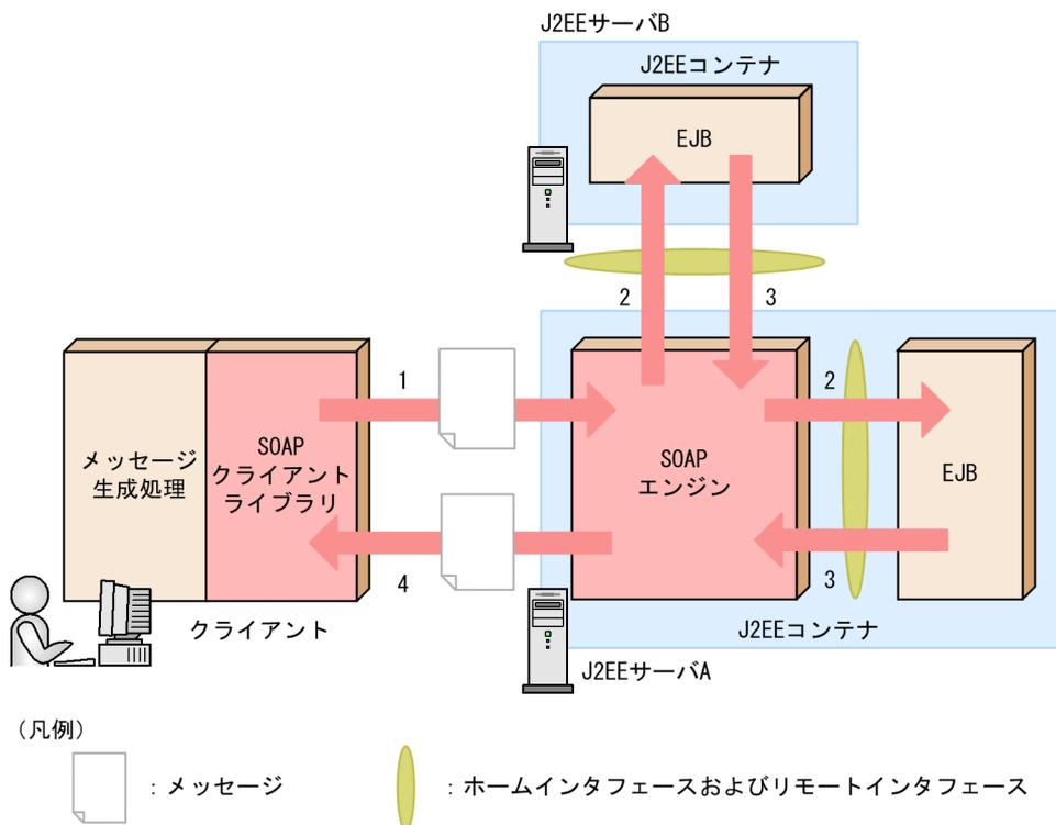
添付ファイルを使用した SOAP アプリケーションを開発する場合、Java インタフェース（リモートインタフェース）から WSDL を生成し、生成した WSDL からサーバおよびクライアントに必要な次のファイルを生成します。
