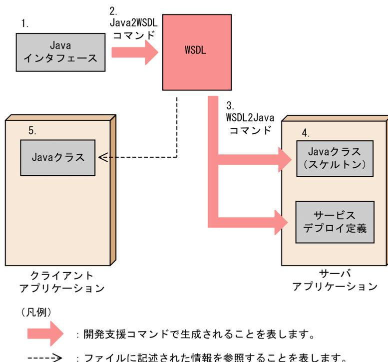
Java インタフェースから WSDL を生成し、生成した WSDL からサーバで使用する Java クラス（スケルトン）およびサービスデプロイ定義を生成します。DII を使用する場合、スタブは使用しません。SOAP サービスの呼び出しに必要な情報を WSDL ファイルから取得します。
