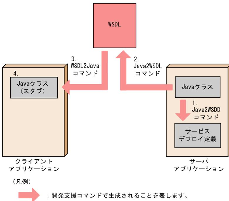
既存の Java クラスから WSDL およびサービスデプロイ定義を生成します。生成した WSDL からクライアントで使用する Java クラス (スタブ) を生成します。
