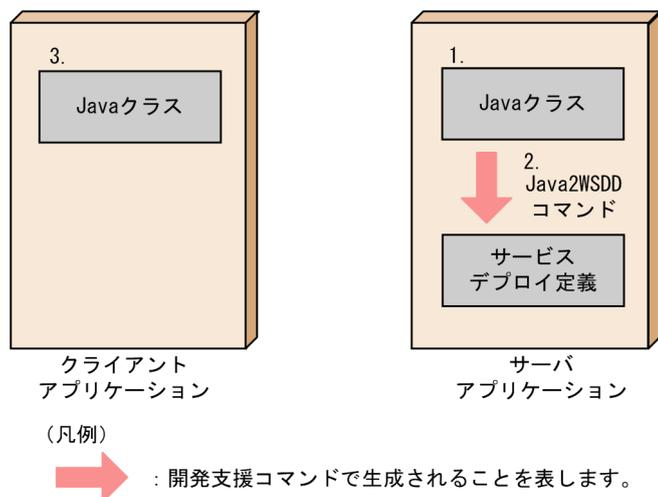
メッセージング形態の SOAP アプリケーションを新規に開発する場合、サーバ側の処理を実装し、実装した Java クラスからサービスデプロイ定義を生成します。また、SAAJ を使用して、クライアント側の処理を実装します。
