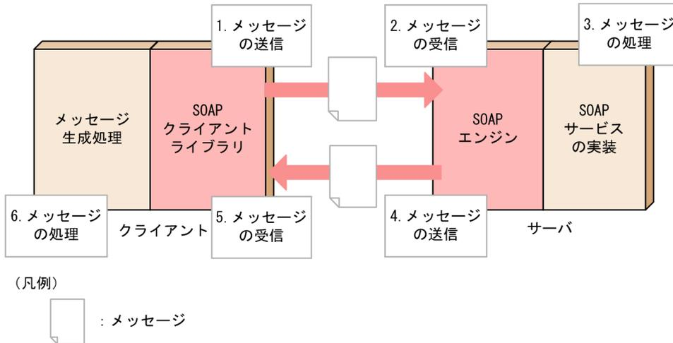
図に示す 1～6 の個所に対し、次に示す処理が正常に行われているかを確認することで、問題発生個所を絞り込めます。
