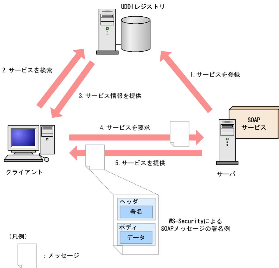
Web サービスでは、柔軟にシステム間を相互接続するという概念上、未知のサービスを発見する手段があります。未知のサービスを発見するために、UDDI レジストリを利用します。UDDI レジストリを利用した Web サービスの利用の流れを示します。
