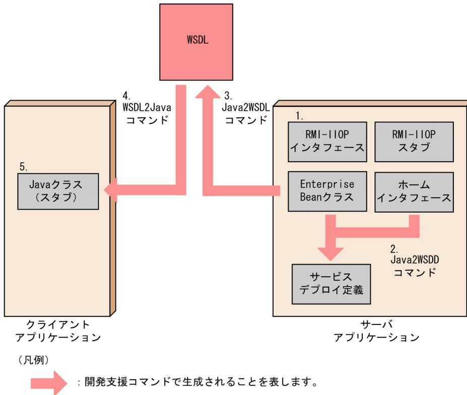
既存の EJB から WSDL およびサービスデプロイ定義を生成します。生成した WSDL からクライアントで使用する Java クラス (スタブ) を生成します。
