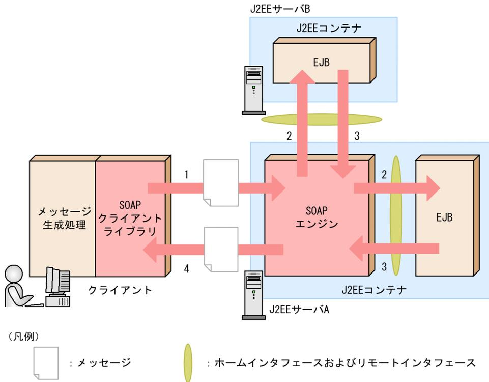
SOAP アプリケーションを新規に開発する場合、Java インタフェース（リモートインタフェース）から WSDL を生成し、生成した WSDL からサーバおよびクライアントに必要な次のファイルを生成します。
