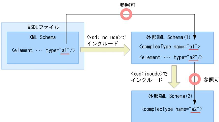
対象となる XML Schema をインクルードしない場合は、別のファイルに記述された XML Schema の要素および属性を参照できません。また、別のファイルを介して、間接的に XML Schema の要素および属性を参照することはできません。
