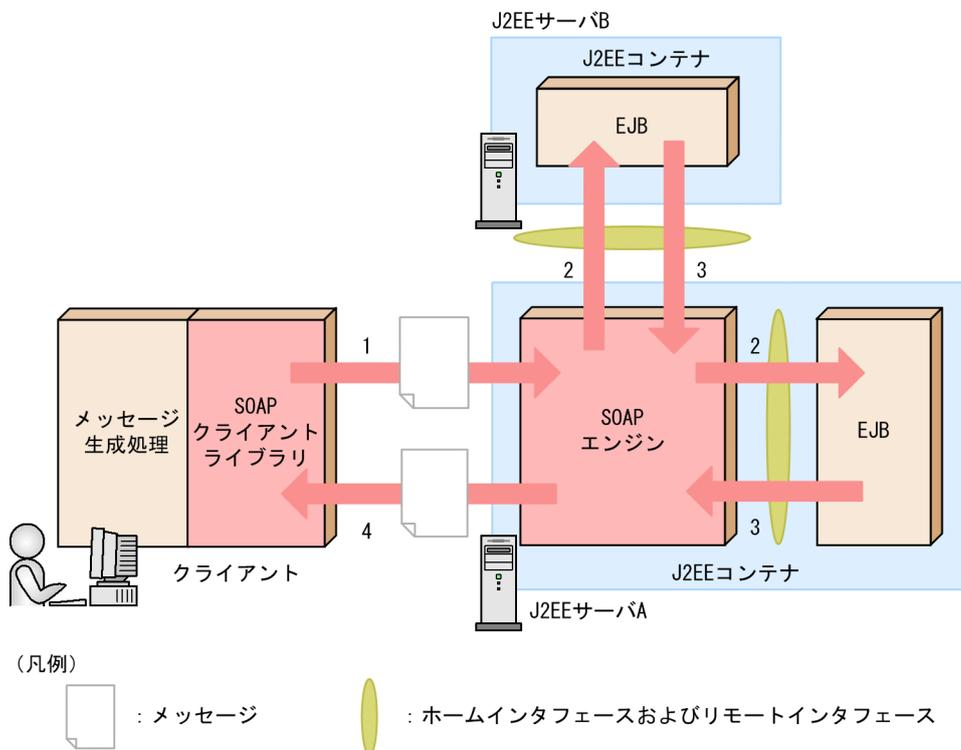
図に沿って、EJB を SOAP サービスのエンドポイントとする形態の処理を説明します。図中に示した番号が次に示す番号に対応しています。
