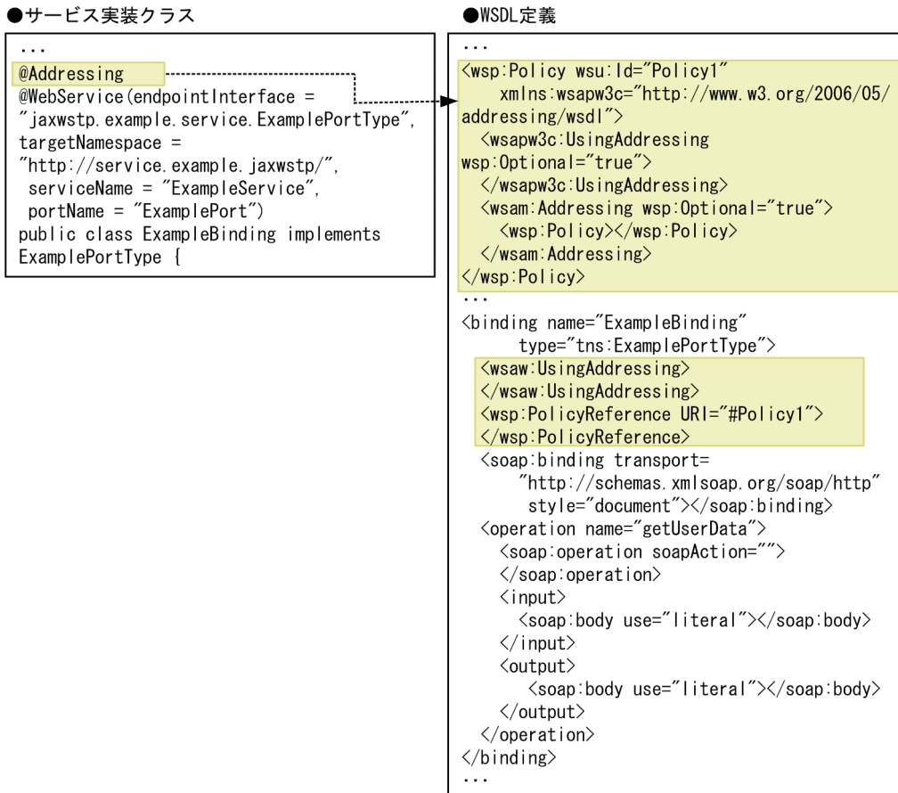
図 16-25 javax.xml.ws.soap.Addressing アノテーションを使用したカスタマイズ例 (Web サービス側)
