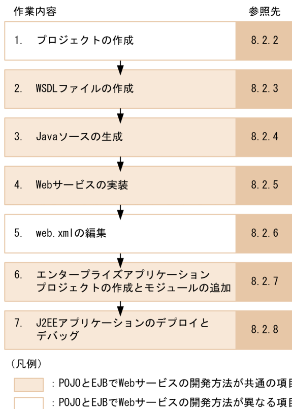
図 8-1 WSDL を起点とした Web サービスの開発の流れ
