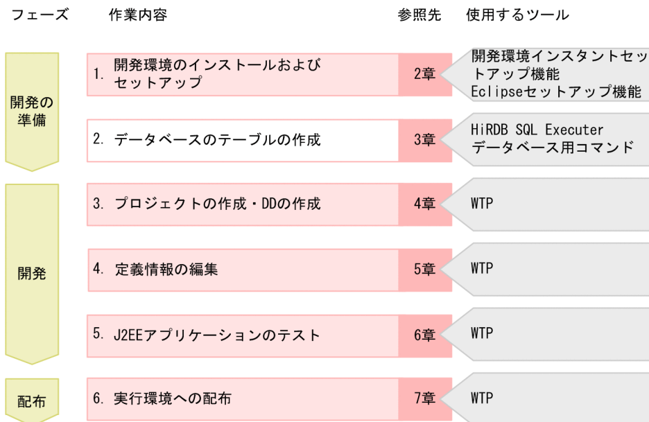
図 1-11 組み込みデータベースと EJB を利用した J2EE アプリケーション開発の流れ
