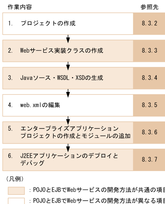
図 8-2 SEI を起点とした Web サービスの開発の流れ
