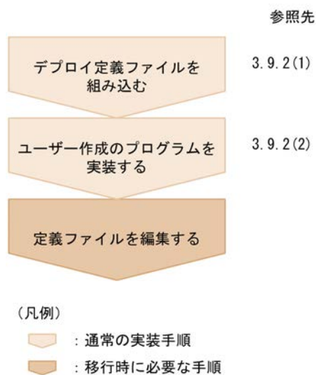
図 B-3 クライアント側がコマンドライン Java アプリケーションの場合の移行手順
