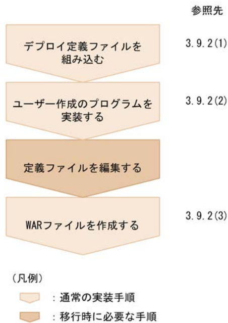
図 B-2 クライアント側が Web アプリケーションの場合の移行手順
