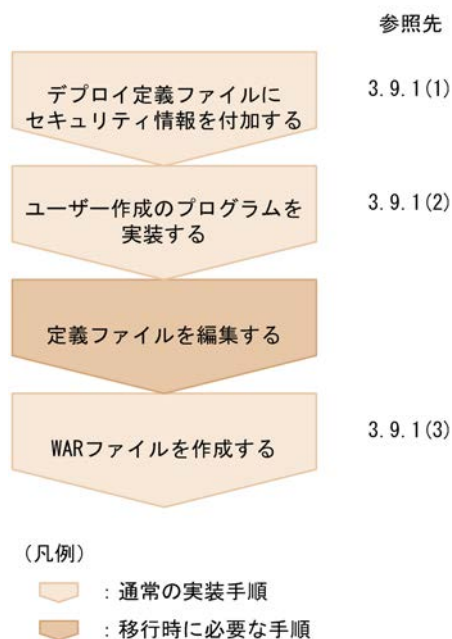
図 B-1 サーバ側の移行手順
