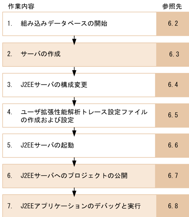
図 6-1 J2EE アプリケーションのテストの流れ図
