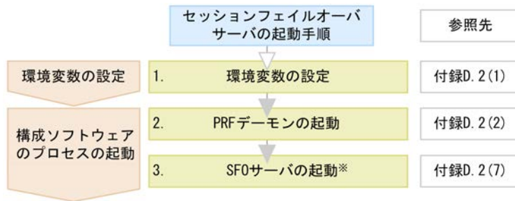
図 D-3 セッションフェイルオーバーサーバの起動の流れ (UNIX の場合)
