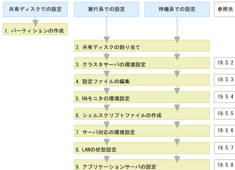
図 19-8 N:1 リカバリシステムの設定手順（UNIX の場合）
