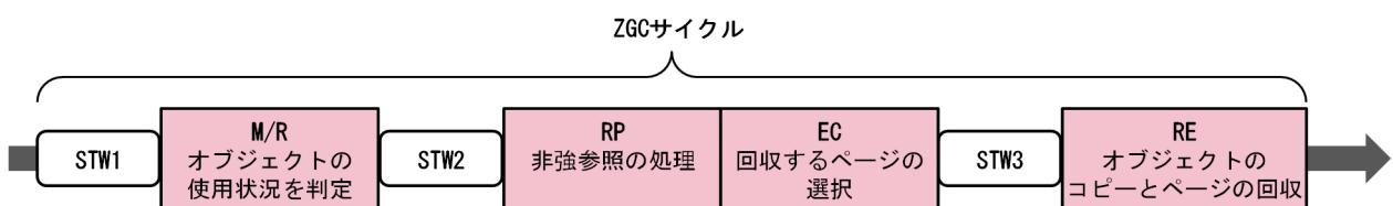
ZGC サイクルは、アプリケーションと GC 処理を並行して実行するフェーズ (M/R, RP, EC, RE) と、アプリケーションを一時停止して GC 処理を実行するフェーズ (STW1, STW2, STW3) で構成されます。
