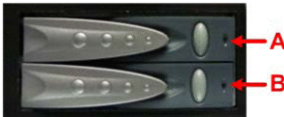
図 3-6 ハードディスク状態表示とアクセス状態表示 LED
