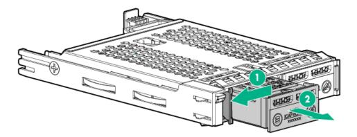
To remove the drive carrier:
