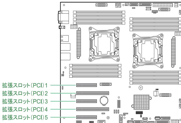
各スロットのバス幅／バスクロック、I/O 電圧、バス No.、デバイス No. およびバススキャンの優先順位と、各スロットに取り付けられる拡張ボードのサイズおよび種類は、次のとおりです。
