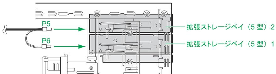
TS20 BN2/CN2/DN2 モデルに使う電源ケーブルは、使用しないほかのケーブルなどとともにナイロンバンドで固定されています。接続する電源ケーブルをナイロンバンドから取り外してください。
