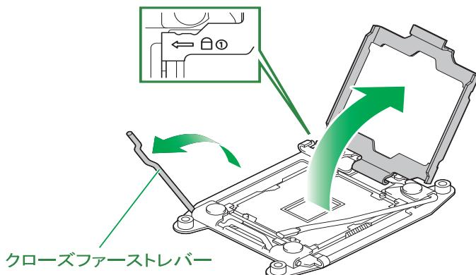
**8** プロセッサースロット2のスロットカバーを開きます。
