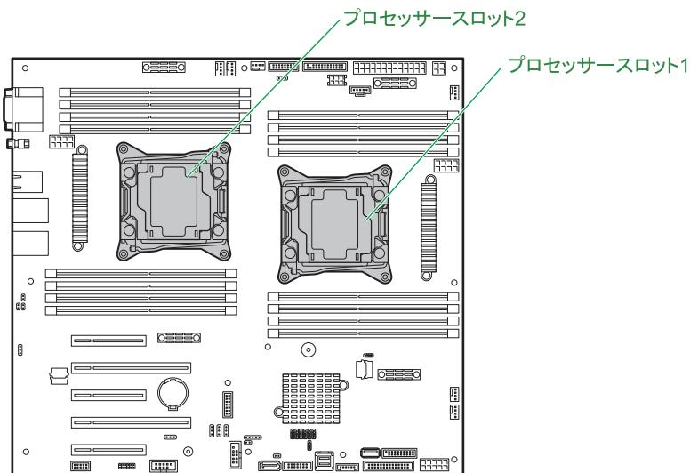
また、プロセッサーを2個搭載した場合、メモリーボードの増設などメモリー構成を変更する必要があります。
