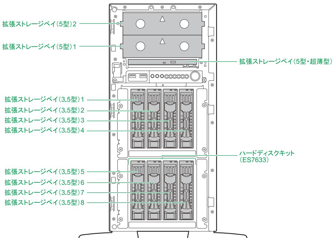
拡張ストレージベイ（3.5型）とシステム装置前面のベイ表示（刻印）は、次のとおり対応しています。
