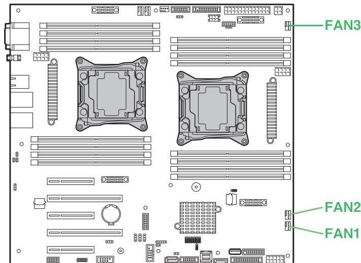
システムファンの電源ケーブルは、余長処理をしてからクランプで固定してください。
