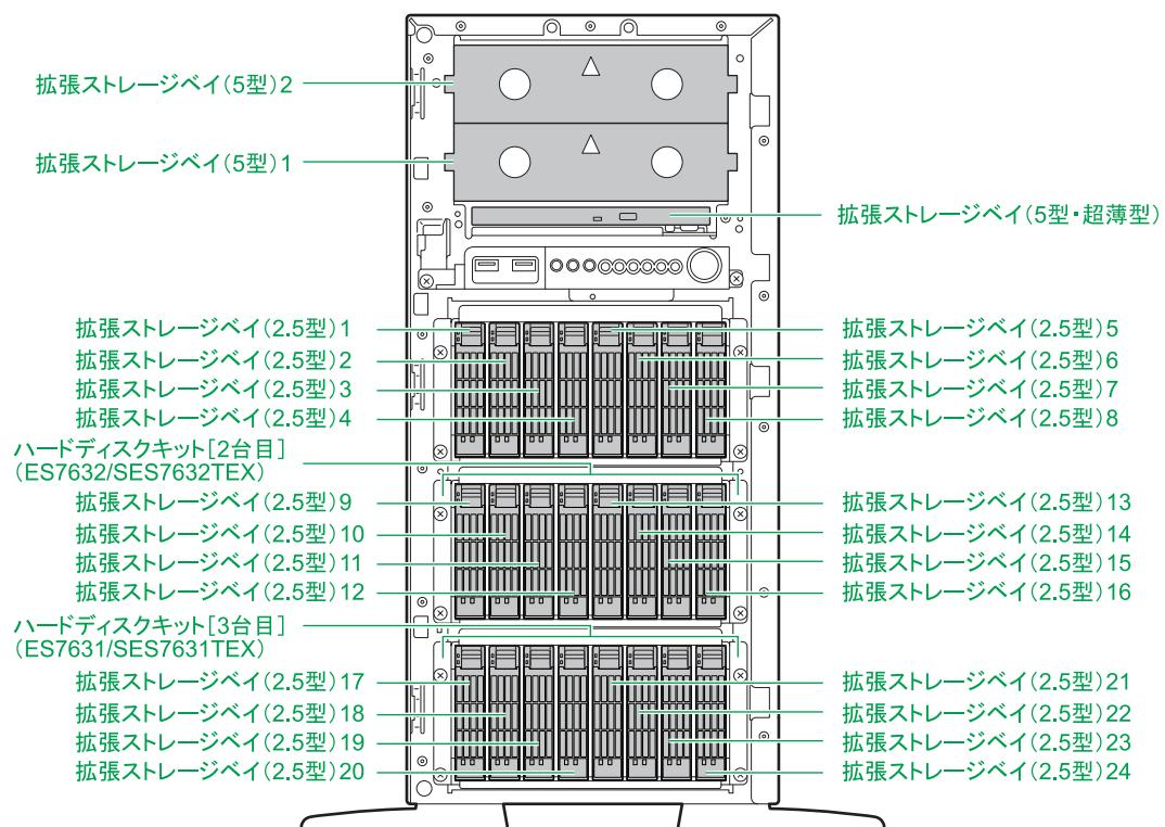
拡張ストレージベイ（2.5型）とシステム装置前面のベイ表示（刻印）は、次のとおり対応しています。
