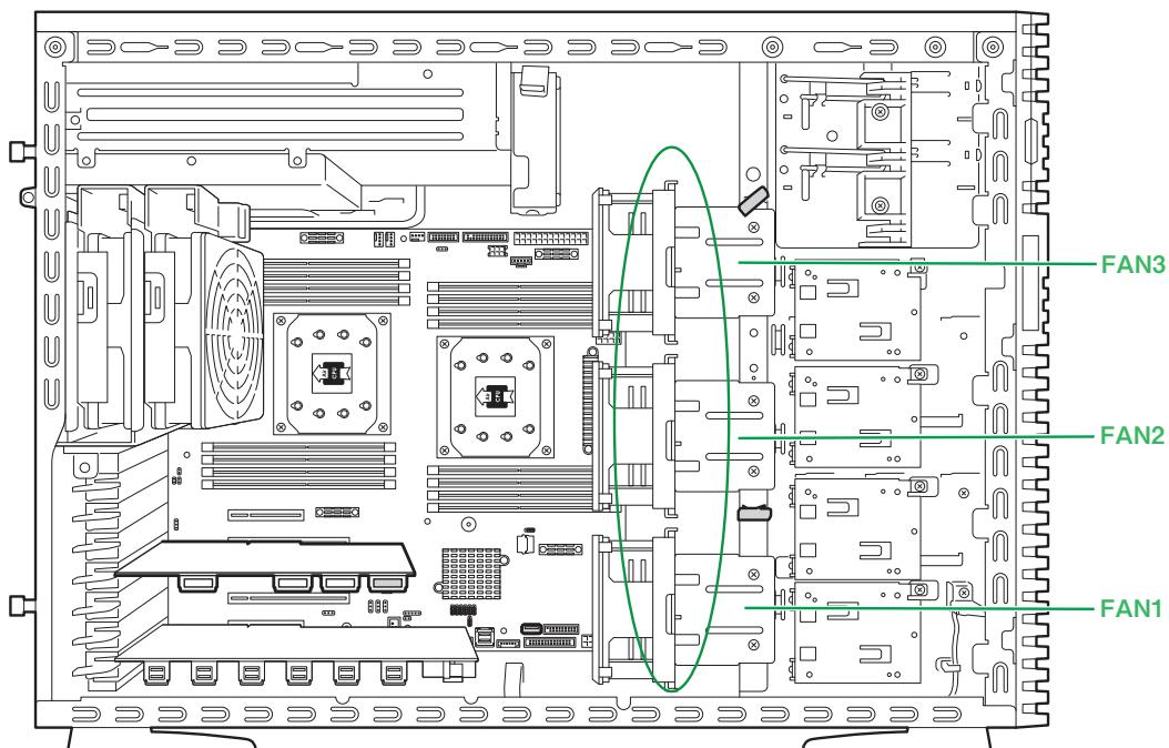
各システムファンの取付ネジ2本を外し、ブラケットごと取り外します。
