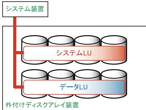
この構成例では、システムとデータの I/O 負荷が分散されます。
