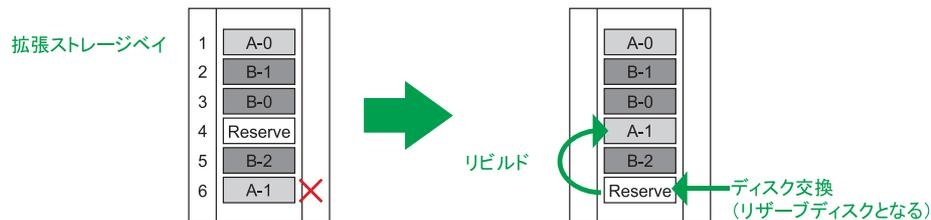
以上のホットスペアの結果、最初の構成と同じ位置にリザーブディスクがありますが、ディスクアレイのデータディスクは A-1 と B-1 が入れ替わってしまいます。つまり、ディスクアレイを構成する物理ドライブは、どの位置にも入れ替わる可能性があります。
