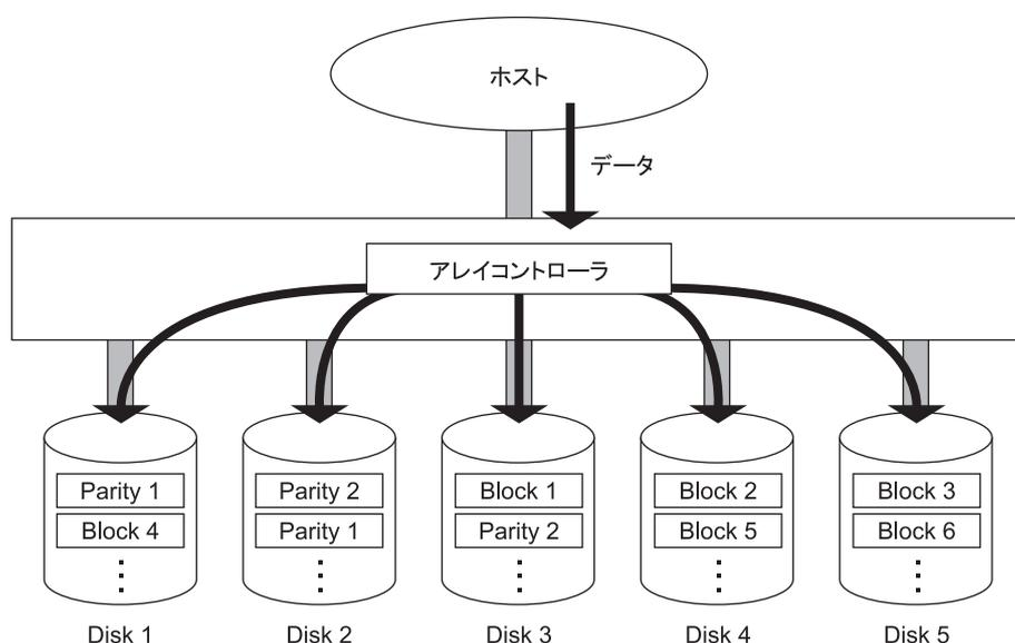
長所： ■ RAID5 と比較して、2 種類のパリティ生成により冗長性が向上します。
