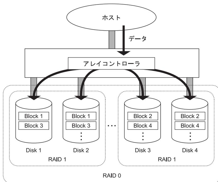
長所： ■ 100% データ・リダンダンスを行います。したがって、1 台の物理ドライブが故障してもほかの物理ドライブにデータがあるため、リード・ライト処理を続けることができます。また、物理ドライブを入れ替えると、業務を停止することなくデータの再構築を行うことができます。
