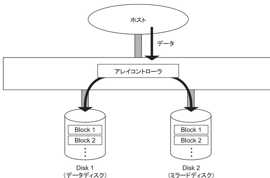
長所： 100% データ・リダンダンシを行います。したがって、1 台の物理ドライブが故障してももう一方の物理ドライブに簡単に切り替えてリード・ライト処理を続けることができます。また、物理ドライブを入れ替えると業務を停止することなくデータの再構築を行うことができます。
