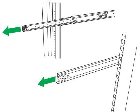
次のイラストのとおり、ロック機構が確実にロックしていることを確認してください。
