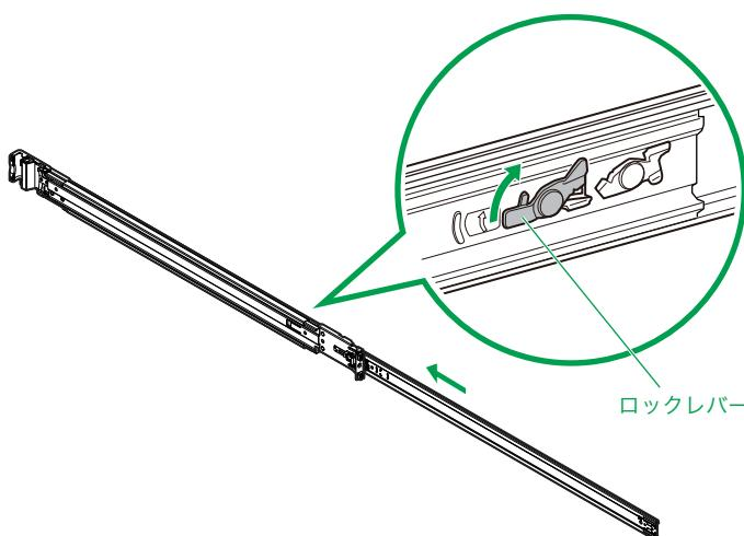
**3 インナーレールをシステム装置側面 4箇所の突起に合わせて、背面側にスライドさせます。**
