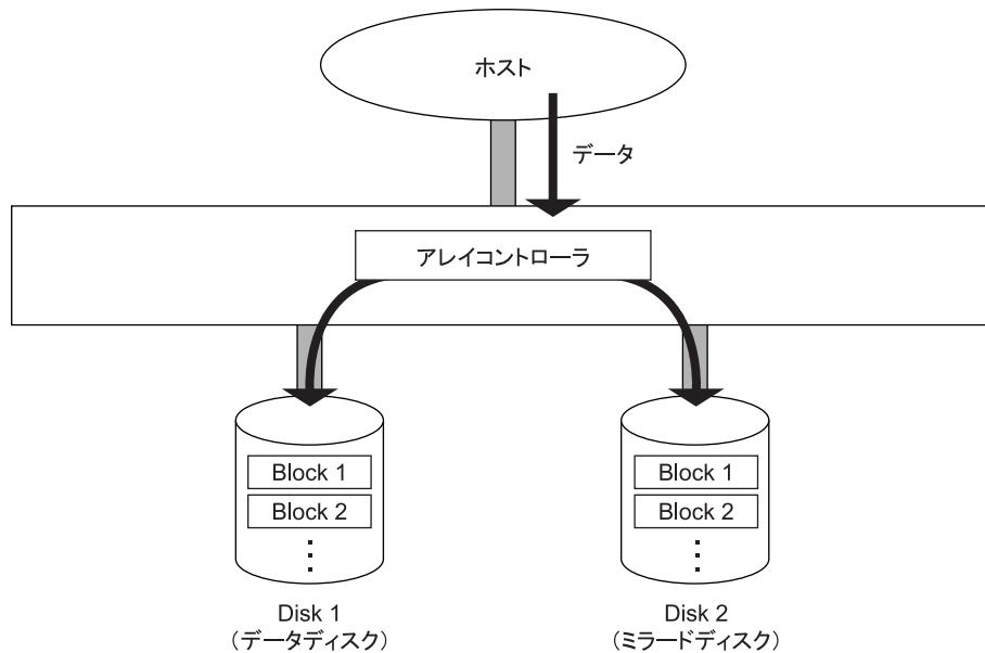
**長所：**100% データ・リダンダンシーを行います。したがって、1台の物理ドライブが故障してももう一方の物理ドライブに簡単に切り替えてリード・ライト処理を続けることができます。また、物理ドライブを入れ替えると業務を停止することなくデータの再構築を行うことができます。
