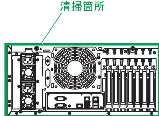
**5** インタフェースケーブルのコネクタおよびシステム装置のコネクタのほこりを取り除き、接続します。
