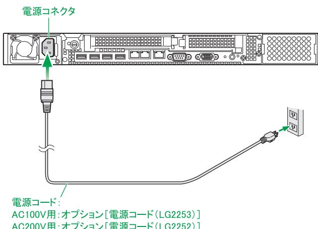
電源コードをシステム装置に接続したあと、脱落防止のため、電源コードを電源ユニットに取り付けられるケーブルクランプで固定します。ケーブルクランプは電源コードを固定したあと、電源プラグの方向に押し込みます。
