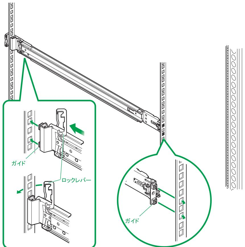
日立製 EP8000 ラックキャビネットに搭載する場合、アウターレール 2 本のフロントおよびリアのガイド合計 4 か所をオプションの EP8000 ラック搭載用ガイド (AU7921) に付け替える必要があります。ガイドを固定している取付ネジ 2 本をプラスドライバで取り外し、EP8000 ラック搭載用ガイドをマイナスドライバで取り付けます。
