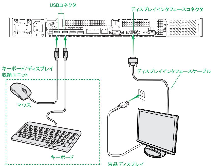
コンソール切替ユニットまたは、コンソール切替ユニットを搭載・内蔵しているディスプレイ／キーボードユニットを接続する場合、システム装置背面のディスプレイインターフェースコネクタおよびUSBコネクタ（リア）にUSB KB／マウス／CRTケーブル（LUB7113A）を接続します。その後、ディスプレイやディスプレイ／キーボードユニット、コンソール切替ユニットの電源プラグをラックキャビネット内のコンセントポックスユニットまたは無停電電源装置（UPS）に接続します。
