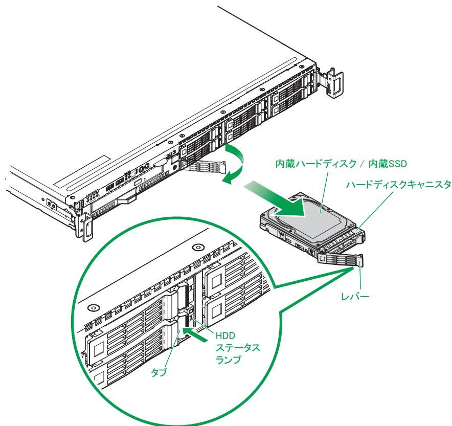
RS110 BM1 モデルの場合、ハードディスクキャニスタのタブを押してロックを解除したあと、レバーを手前に引いて引き出します。
