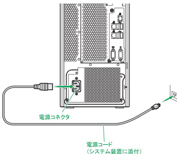
電源コードをシステム装置に接続したあと、脱落防止のため、電源コードを電源ユニットに取り付けられているケーブルクランプで固定します。ケーブルクランプは電源コードを固定したあと、電源プラグの方向に押し込みます。
