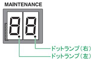
動作状態の表示はイベントコードと POST コード、消費電力があり、SERVICE ランプスイッチにより表示を切り替え、ドットランプ (左)、ドットランプ (右) および SERVICE ランプスイッチの消灯/点灯の組み合わせにより現在の動作状態を示します。
