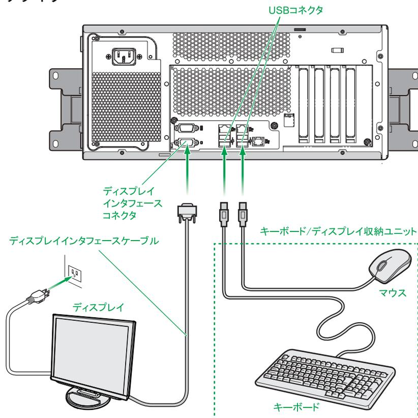
コンソール切替ユニットまたはコンソール切替ユニットを搭載・内蔵しているディスプレイ／キーボードユニットを接続する場合、システム装置背面のディスプレイインタフェースコネクタおよび USB コネクタ（リア）に USB KB /マウス / CRT ケーブル（LUB7113A）を接続したあと、ディスプレイやディスプレイ／キーボードユニット、コンソール切替ユニットの電源プラグをコンセントに接続します。ラックタイプではラックキャビネット内のコンセントボックスユニットまたは無停電電源装置（UPS）に接続してください。
