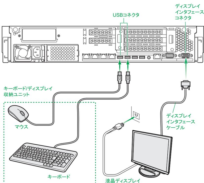
コンソール切替ユニットまたは、コンソール切替ユニットを搭載・内蔵しているディスプレイ/キーボードユニットを接続する場合、システム装置背面のディスプレイインタフェースコネクタおよびUSBコネクタ（リア）にUSB KB / マウス / CRT ケーブル（LUB7113A）を接続します。その後、ディスプレイやディスプレイ/キーボードユニット、コンソール切替ユニットの電源プラグをラックキャビネット内のコンセントボックスユニットまたは無停電電源装置（UPS）に接続します。
