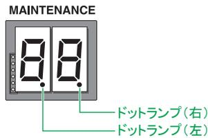
動作状態の表示はイベントコードと POST コード、消費電力があり、SERVICE ランプスイッチにより表示を切り替えます。ドットランプ（左）、ドットランプ（右）および SERVICE ランプスイッチの消灯／点灯の組み合わせにより現在の表示内容を示します。
