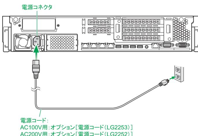
電源コードをシステム装置に接続したあと、脱落防止のため、電源コードを電源ユニットに取り付けられているケーブルクランプで固定します。ケーブルクランプは電源コードを固定したあと、電源プラグの方向に押し込みます。
