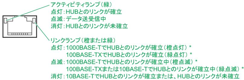
\*: システム装置がAC給電・スタンバイ状態の場合、10BASE-Tでリンクが確立するため消灯します。
