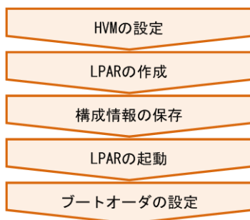
図 1-3 ゲストスクリーンによるブートオーダー設定の流れ
