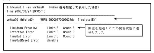
【実行例 4】障害閾値管理機能を OS 稼動中に一時的に停止します。(vmhba20 にて短時間 Linkdown が 2 回発生している状態)
