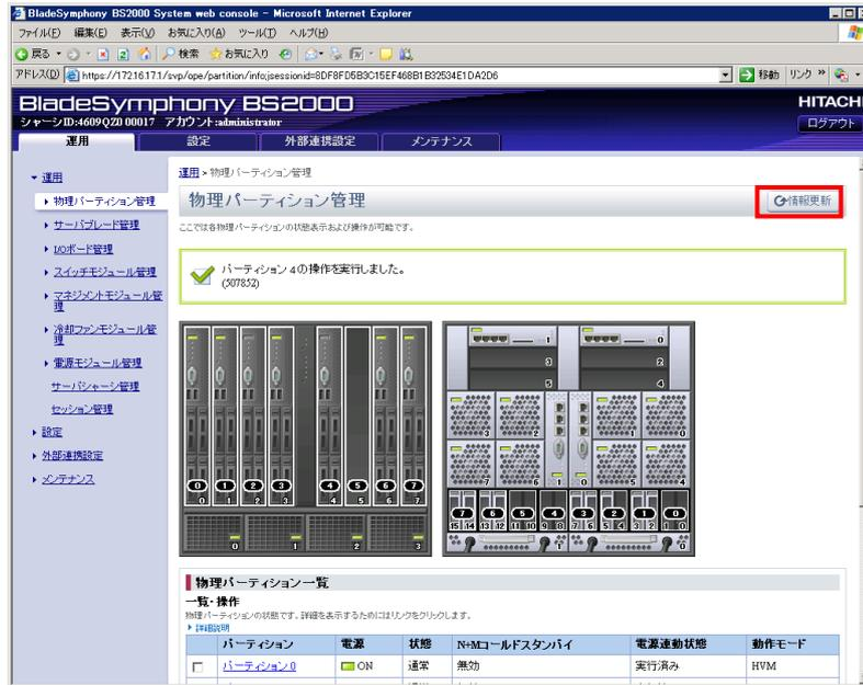
(f) 対象サーバブレードの電源が ON になっていることを確認します。
