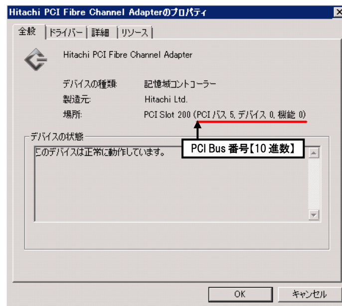
Fibre Channel アダプタのプロパティ画面(例)
