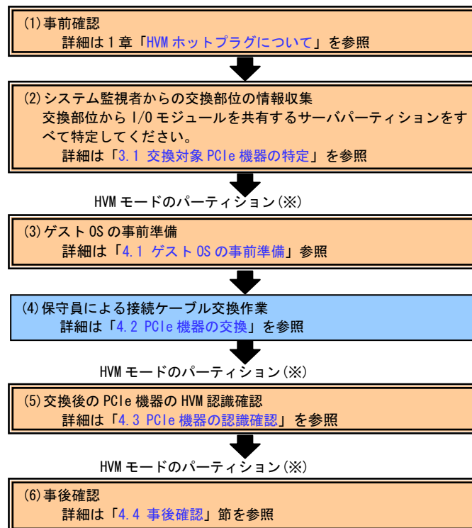
図 4 BS2000 I/O スロット拡張装置 接続ケーブルの交換手順
