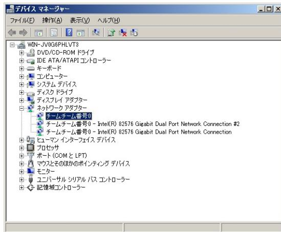
LAN 拡張機能を設定した後、「コントロールパネル」の[ネットワークとインターネット]の[ネットワークの状態とタスクの表示]をクリックします。[ネットワークと共有センター]画面が表示されるので[アダプターの設定の変更]をクリックし、[ネットワーク接続]画面で[ローカルエリア接続]が1つ追加されたことを確認してください。
