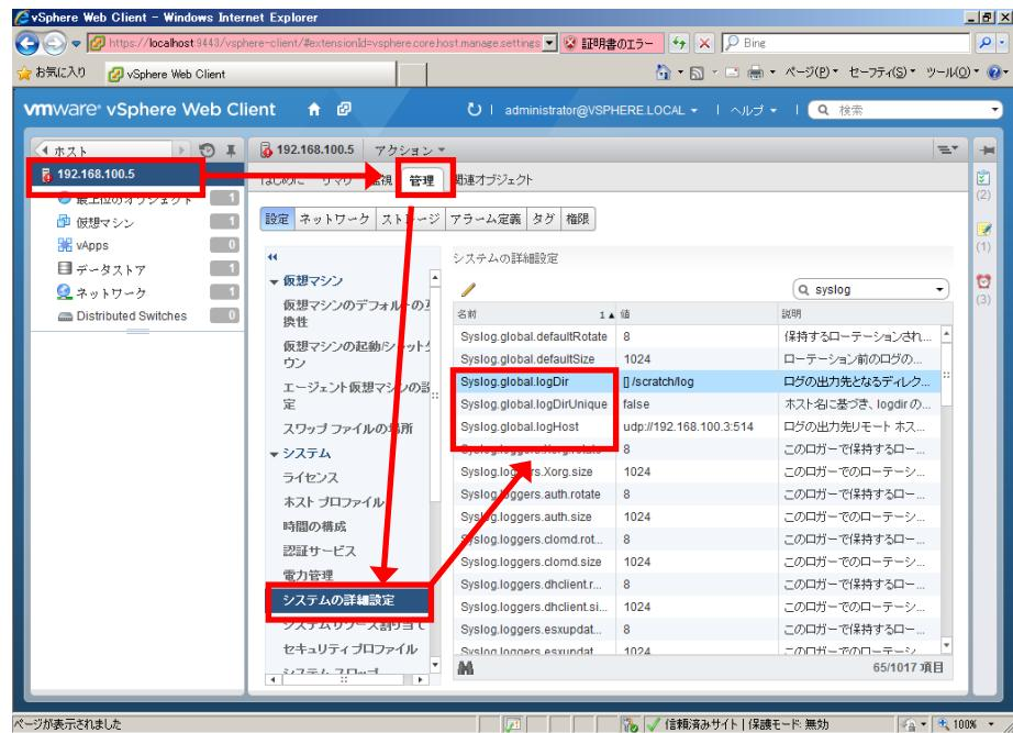
4. システムの詳細設定で「Syslog.global.logDir」を選択し、「詳細オプションの編集」画面で、設定を下記のように変更して OK を押します。
