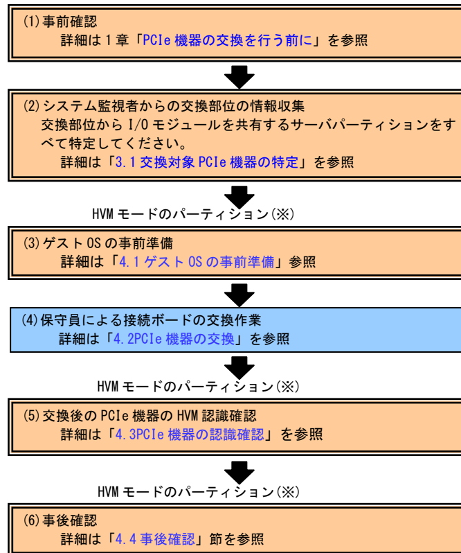
図 5 BS2500 I/O スロット拡張装置 接続ボードの交換手順
