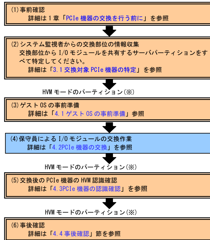
図 3 BS2500 I/O スロット拡張装置 I/O モジュールの交換手順
