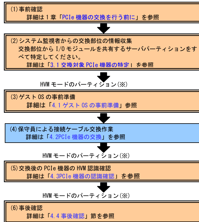
図 4 BS2500 I/O スロット拡張装置 接続ケーブルの交換手順
