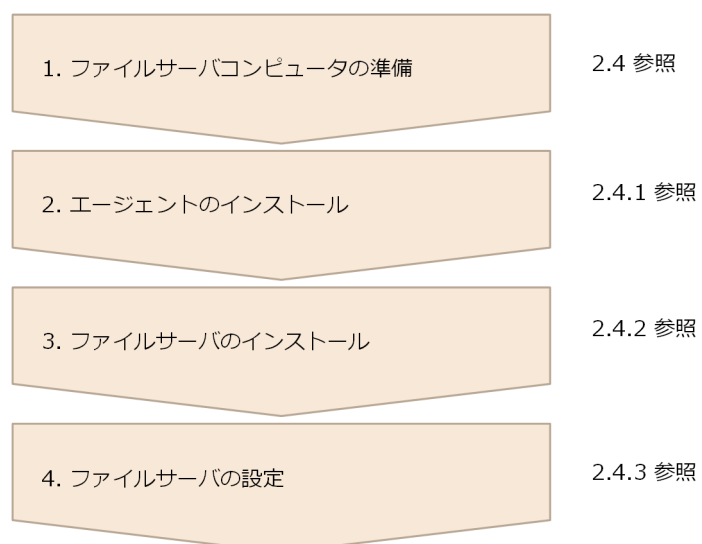
図 2-3 ファイルサーバの構築の流れ
