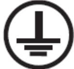
この記号は、ラックのフレーム上に表示されています。保護接地伝導体は、すべてその点で終端される必要があります。公認または認証された閉ループ・コネクター(リング・ターミナル)を使用して、ボルトまたはスタッドによって止め座金でフレームにしっかりと固定される必要があります。コネクターは、ボルトまたはスタッド、止め座金に適合する適切なサイズである必要があります。使用される導線の定格、およびブレーカーの定格が考慮される必要があります。フレームが、保護接地伝導体に電気的に結合されているのを確実にすることを意図しています。ボルトまたはスタッドに入る端末コネクターおよび止め座金が接触する穴は、金属同士の接触を考慮に入れ、いかなる非導電性材料も排除する必要があります。
