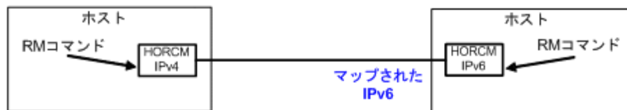
図 19 IPv4 mapped IPv6 用のネットワーク構成
