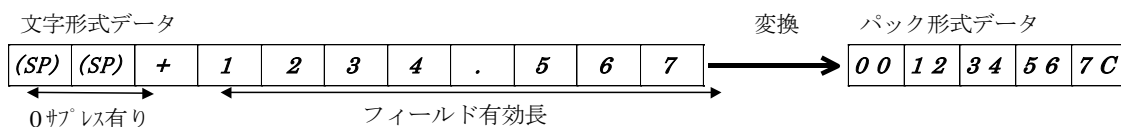
図 9.2.8 小数点桁数3、0サプレス有り、符号位置が有効桁の前の変換概要
