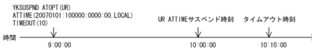
図 69 YKSUSPND コマンド実行時刻、UR ATTIME サスペンド時刻、タイムアウト時刻の関係
