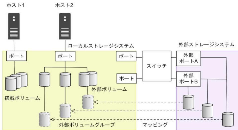
図では、Universal Volume Manager によってローカルストレージシステムに他のストレージシステムを接続しています。ローカルストレージシステムは、外部ストレージシステム接続用のポートからスイッチを経由して、外部ストレージシステムと接続しています。接続した外部ストレージシステムのボリュームは、ローカルストレージシステムのボリュームとしてマッピングされています。
