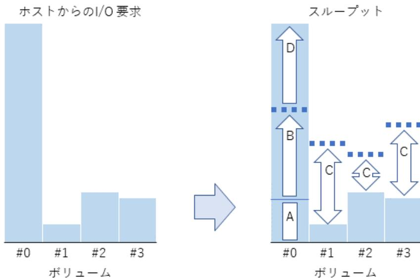
上記の状態、ボリューム #1~3 に対するホストからの I/O 要求も増えると、ボリューム #1~3 に I/O の起動順序を優先的に割り当てて、下限値を満たすように制御します（下に示すボリュームの #1~3 の E）。ボリューム #0 は、すでにスループットが下限値を超えているため、I/O の起動順序が下げられます。これにより、スループットを下限値付近まで下げます（ボリューム #0 の F）。
