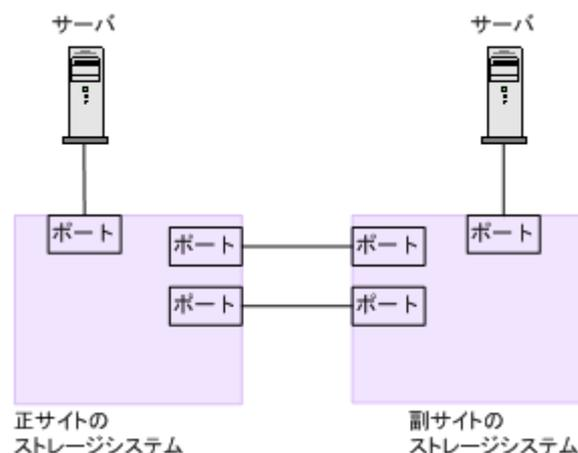
ストレージシステム間の接続に使用するパッケージおよびプロトコルの設定によって、Fabric やトポロジの設定が次のとおり異なります。また、設定できるリンクスピードも異なります。Auto はトポロジ、Fabric に関係なく設定できます。
