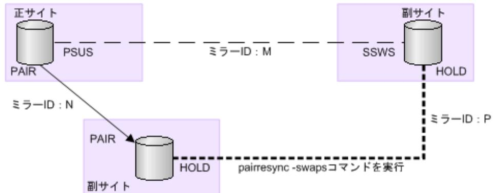
デルタリシンク用ペア (ミラーID : P) に対して pairresync -swapsコマンドを実行し、コマンドの実行結果を確認します。
