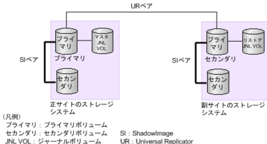
ShadowImage ペアのプライマリボリュームを共有するこれらの構成では、ShadowImage ペアのプライマリボリュームの状態が RCPY のときは、Universal Replicator ペアを削除する操作しかできません。ShadowImage ペアのプライマリボリュームの状態に応じた Universal Replicator ペアの操作可否を次の表に示します。
