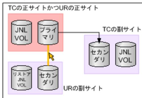
↓ RAID Managerを使って、URの正サイトとURの副サイトの間でURペアを作成します。システムが3DCマルチターゲット構成に戻ります。
