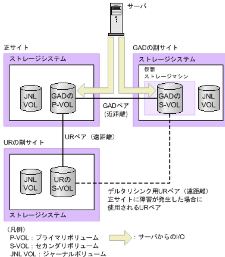
global-active device の副サイトから Universal Replicator の副サイトへデルタリシンク用の Universal Replicator ペアがあるため、正サイトで障害が発生したときには global-active device の副サイトにあるジャーナルデータを使って Universal Replicator ペアのセカンダリボリュームを同期できます。
