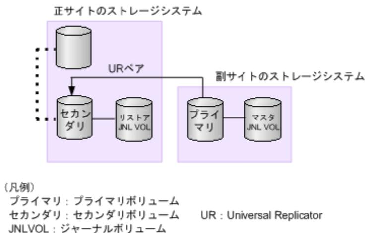
3. Universal Replicator ペアに対して RAID Manager の horctakeover コマンドを実行し、コピー方向を元に戻してペアを再作成します。
