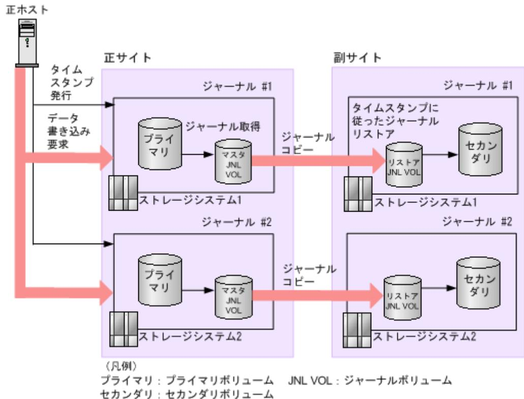
複数の正サイトのストレージシステムおよび副サイトのストレージシステムを組み合わせさせた構成では、正ホストの RAID Manager から一定の間隔でタイムスタンプが発行されます。このタイムスタンプは、Universal Replicator のプライマリボリュームに書き込むデータに追加されます。副サイトのストレージシステムでは、タイムスタンプの古いデータから順にデータボリュームにリストアすることでデータの更新順序を保ちます。タイムスタンプを用いて複数のストレージシステム間の更新ポイントを合わせるため、コンシステンシーを維持しながらデータをコピーできます。
