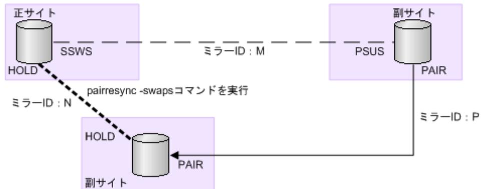
デルタリシンク用ペア（ミラーID：N）に対して`pairresync -swaps`コマンドを実行し、コマンドの実行結果を確認します。
