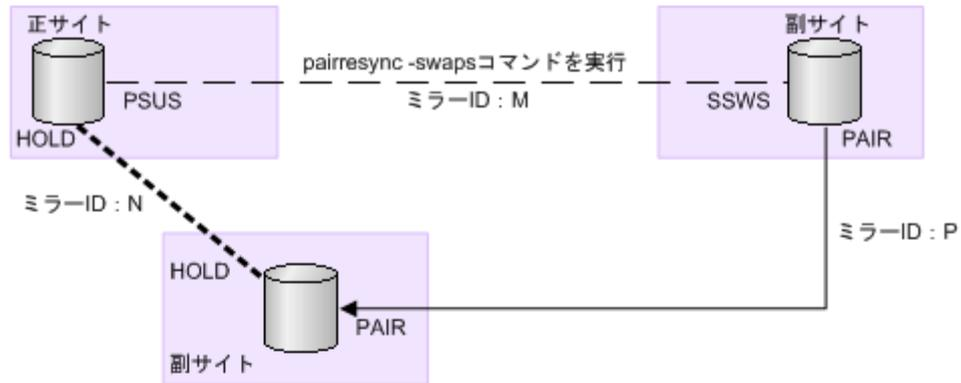
切り替え先の副サイトでの業務処理を停止したあとに、`pairresync -swaps`コマンドを実行して、ペア（ミラーID：M）の正副を入れ替えます。
