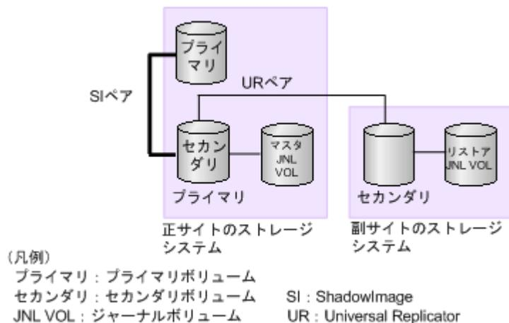
この構成では、Universal Replicator ペアを作成する前に、ShadowImage ペアを PAIR 状態にしたあと分割して、PSUS 状態にする必要があります。ShadowImage ペアのセカンダリボリュームの状態に応じた Universal Replicator ペアの操作可否を次の表に示します。
