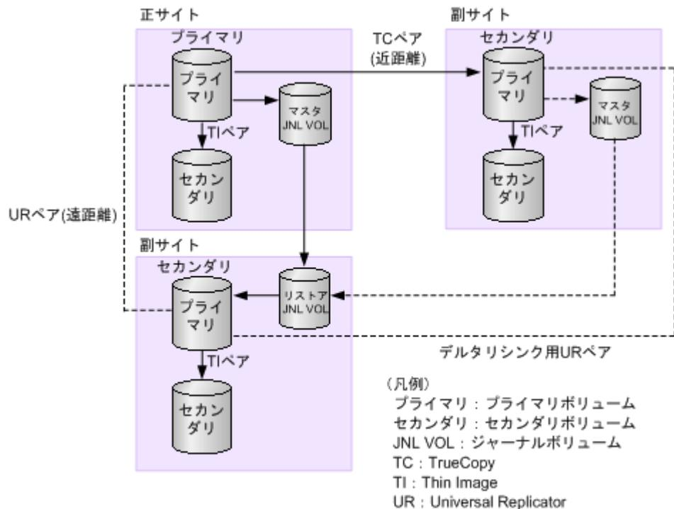
副サイトに Thin Image ペアを作成するためには、デルタリシンクに対応した 3DC マルチターゲット構成を先に作成する必要があります。また、3つの Universal Replicator サイトに対応した 3DC マルチターゲット構成および 3DC カスケード構成の場合、3DC マルチターゲット構成および 3DC カスケード構成を先に作成する必要があります。
