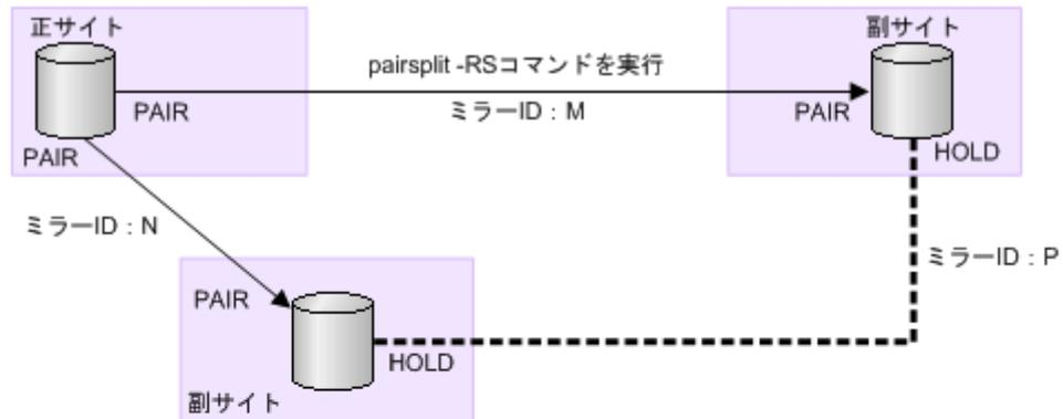
副サイトのペア (ミラーID : M) に対して pairsplit -RSコマンドを実行し、コマンドの実行結果を確認します。
