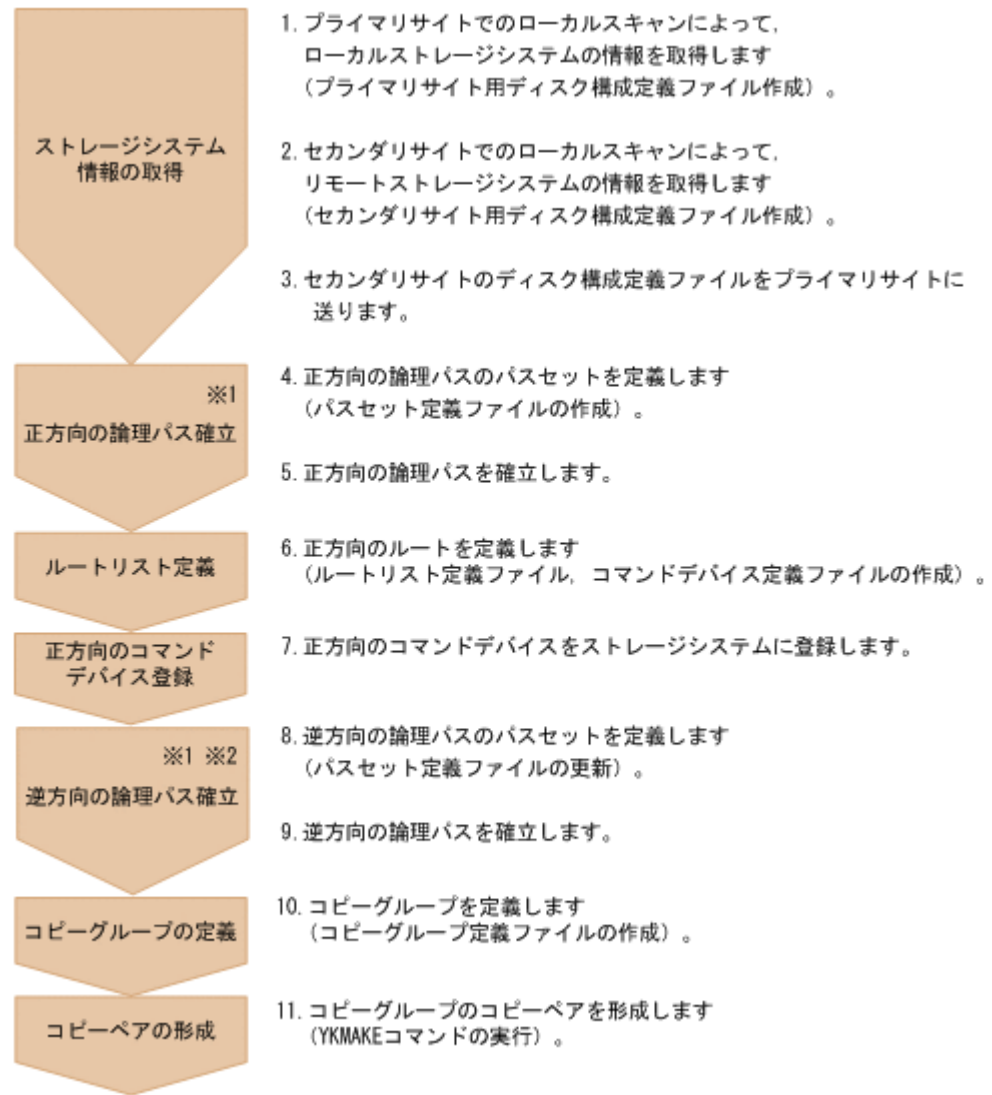
図 5-3 2DC 構成をプライマリサイトで運用するための定義フロー（ケース A）
