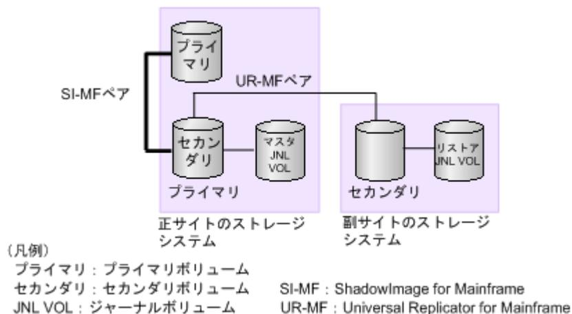
この構成では、Universal Replicator for Mainframe ペアを作成する前に、ShadowImage for Mainframe ペアを DUPLEX 状態にしたあと分割して、Split/SUSPOP 状態にする必要があります。ShadowImage for Mainframe ペアのセカンダリボリュームの状態に応じた Universal Replicator for Mainframe ペアの操作可否を次の表に示します。
