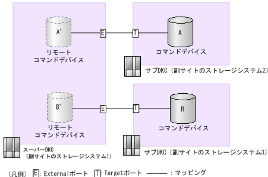
ファイバチャネルスイッチを使用して、Target ポートは副サイトのストレージシステムにある Bidirectional ポートに接続できます。
