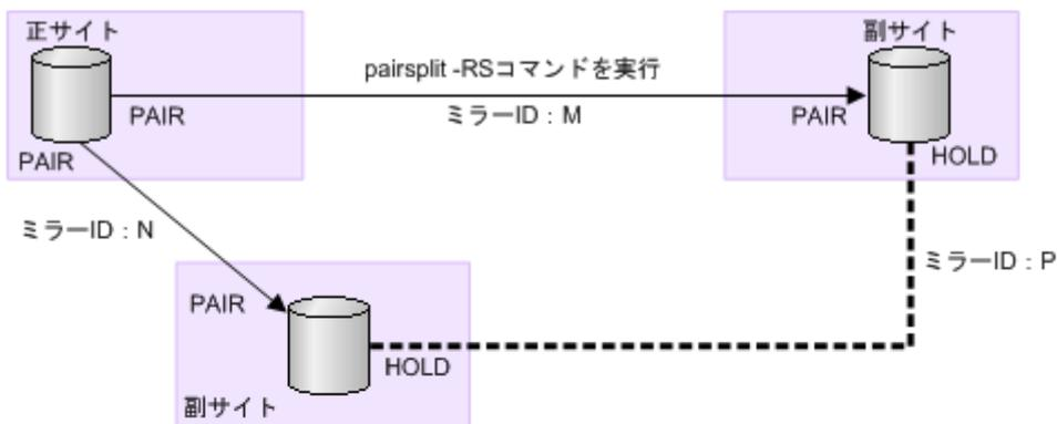
副サイトのペア（ミラーID：M）に対してpairsplit -RSコマンドを実行し、コマンドの実行結果を確認します。
