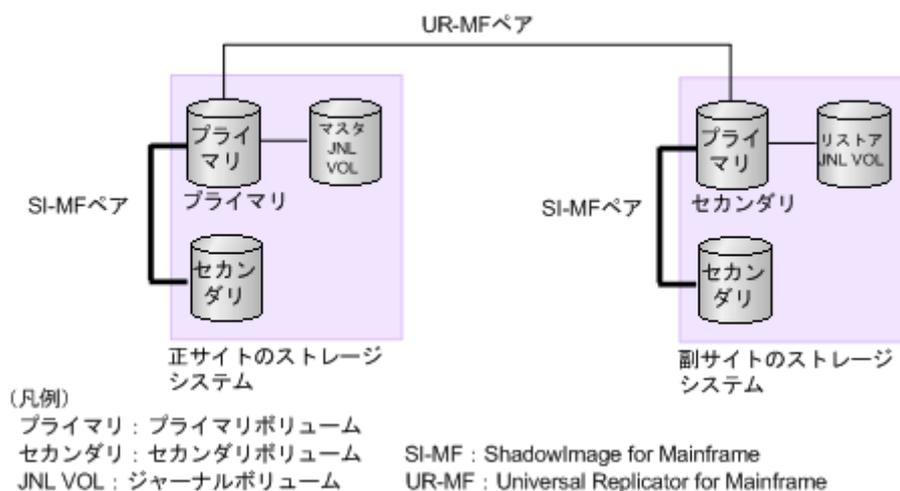
ShadowImage for Mainframe ペアのプライマリボリュームを共有するこれらの構成では、ShadowImage for Mainframe ペアのプライマリボリュームの状態が Resync-R/REVRSY のときは、Universal Replicator for Mainframe ペアを削除する操作しかできません。ShadowImage for Mainframe ペアのプライマリボリュームの状態に応じた Universal Replicator for Mainframe ペアの操作可否を次の表に示します。
