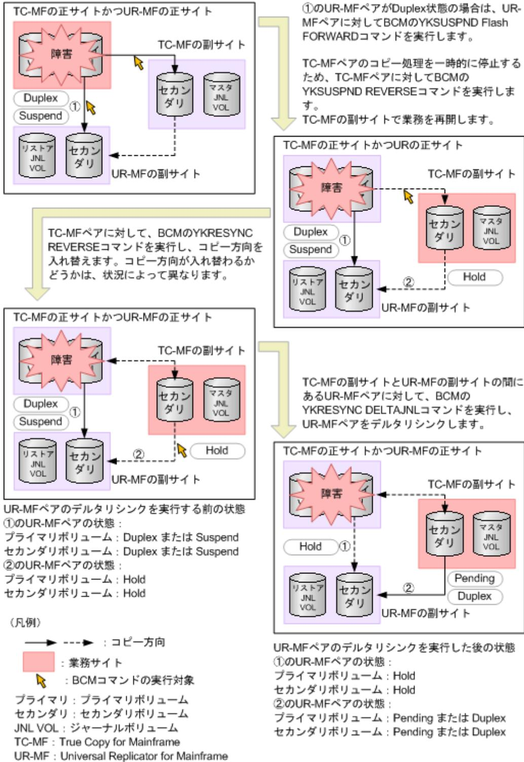
(1) TrueCopy for Mainframe 副サイトから正サイトに業務を戻す（3DC マルチターゲット構成でデルタリシンク処理を実行した場合）
