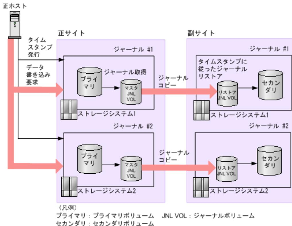
複数の正サイトのストレージシステムおよび副サイトのストレージシステムを組み合わせた構成では、正ホストの RAID Manager から一定の間隔でタイムスタンプが発行されます。このタイムスタンプは、Universal Replicator for Mainframe のプライマリボリュームに書き込むデータに追加されます。副サイトのストレージシステムでは、タイムスタンプの古いデータから順にデータボリュームにリストアすることでデータの更新順序を保ちます。タイムスタンプを用いて複数のストレージシステム間の更新ポイントを合わせるため、コンシステンシーを維持しながらデータをコピーできます。
