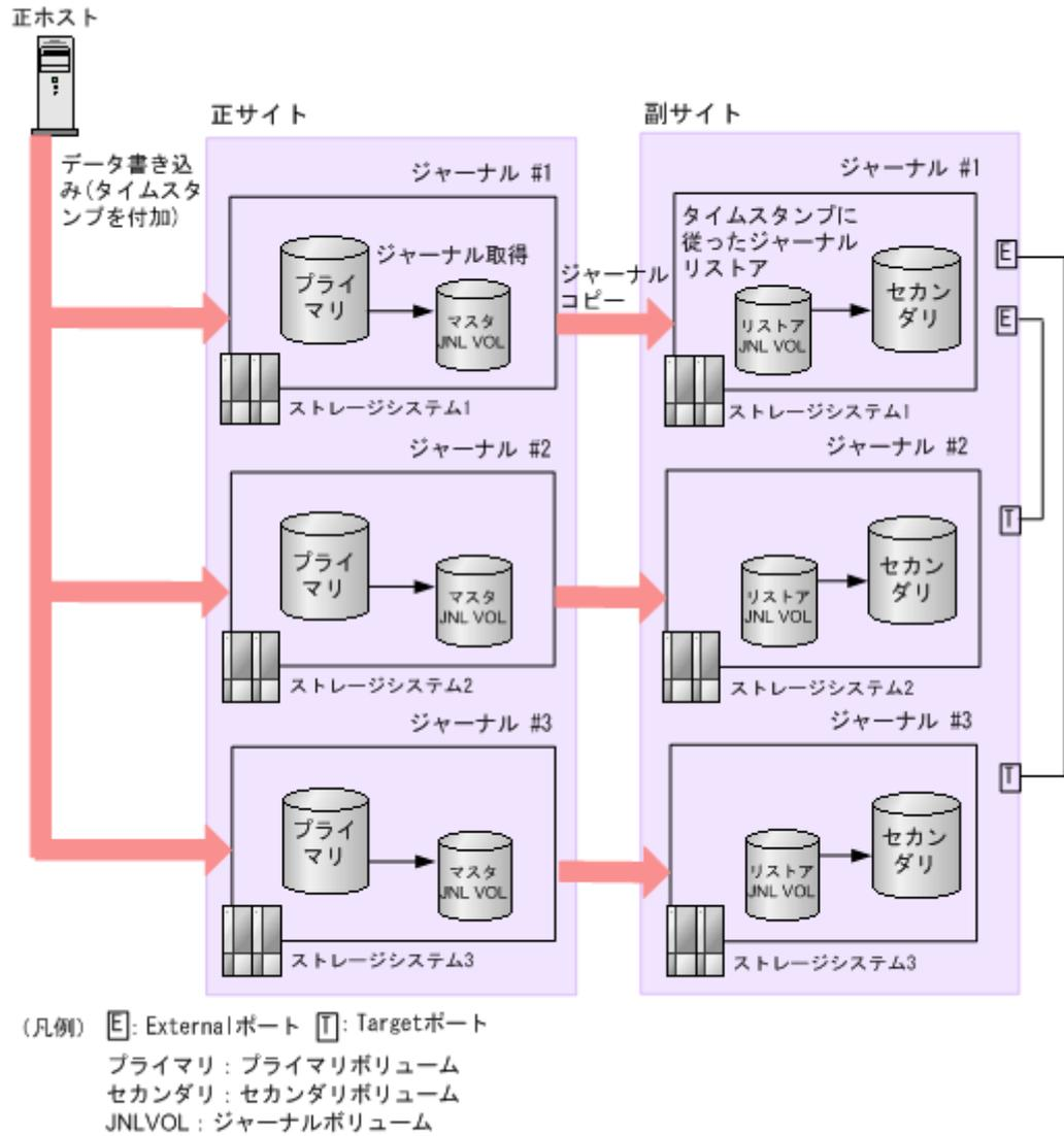
複数の正サイトのストレージシステムと副サイトのストレージシステムを組み合わせた構成では、正ホストはプライマリボリュームにデータを書き込む際、データにタイムスタンプを追加します。副サイトのストレージシステムはタイムスタンプをチェックし、古いデータから順にデータボリュームにリストアし、データの更新順序を保ちます。タイムスタンプ機能の詳細については、「[3.6.1 ホスト I/O タイムスタンプ](#)」を参照してください。
