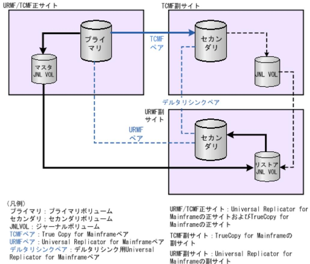
デルタリシンク用の Universal Replicator for Mainframe ペアの作成手順を次に示します。
