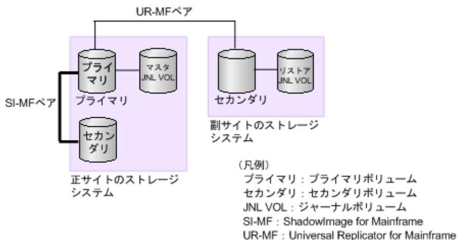
Business Continuity Manager を利用すると、バックアップコピーの開始時刻をジャーナルに設定できます。上記の構成で、バックアップコピーの開始時刻を設定しておく、その時刻までにプライマリボリュームに書き込まれるデータは、セカンダリボリュームにバックアップされるようになります。上記の構成が複数ストレージシステムの複数ジャーナルボリュームで使われている場合は、すべてのジャーナルに同一のバックアップコピー開始時刻を設定できます。これによって、プライマリボリュームのバックアップが複数のストレージシステムで同時に行われるようになります。
