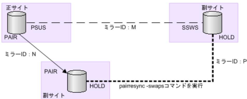
デルタリシンク用ペア（ミラーID：P）に対してpairresync -swapsコマンドを実行し、コマンドの実行結果を確認します。
