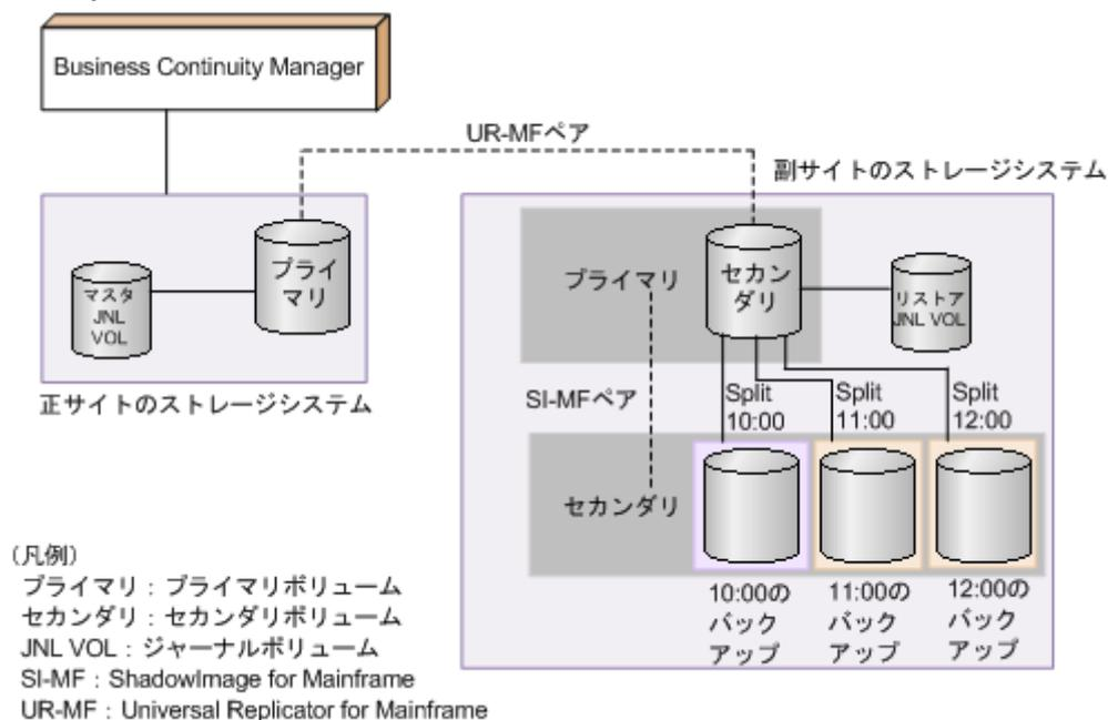
Universal Replicator for Mainframe と ShadowImage for Mainframe を連携させた ATTIME サスペンド機能の仕様を次に示します。
