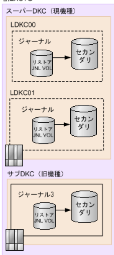
図 19 VSP G1000, VSP G1500, VSP F1500 または VSP を副サイトのストレージシステムのサブDKC に設定できる構成例
