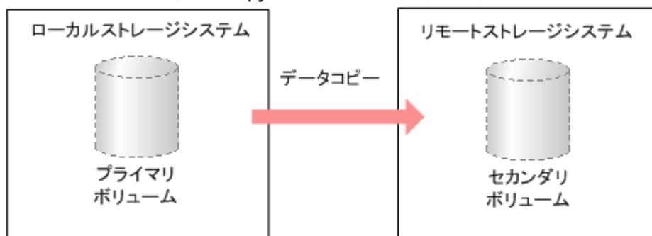
Dynamic Provisioning for Mainframe、Dynamic Tiering for Mainframe、または active flash for mainframe と TrueCopy for Mainframe を併用した場合、仮想ボリュームをコピーできます。
