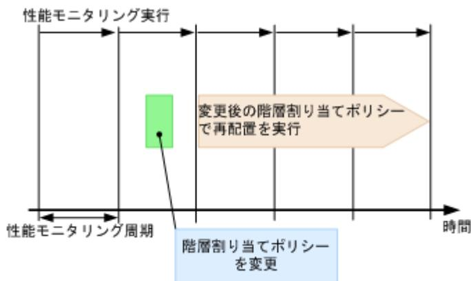
階層再配置の実行モードを手動実行モードに設定しているときに階層割り当てポリシーを変更した場合、性能モニタリングを手動で実行してから階層の再配置を実行してください（「[図 29 手動実行モードでの階層割り当てポリシー変更後の階層の再配置](#)」のケース 1）。モニタリング情報が採取されているときに階層割り当てポリシーを変更した場合、階層の再配置を実行する際にそのモニタリング情報が使用されます（「[図 29 手動実行モードでの階層割り当てポリシー変更後の階層の再配置](#)」のケース 2）。このため、新たに性能モニタリングを実行する必要はありません
