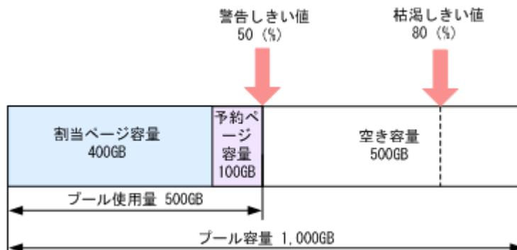
ESE-VOL が関連づけられているプールの使用量がしきい値を超えた場合は、SIM と SNMP トラップに加えて、オンライン状態になっている IBM z/OS 上の SYSLOG に、次の警告メッセージが出力されます。
