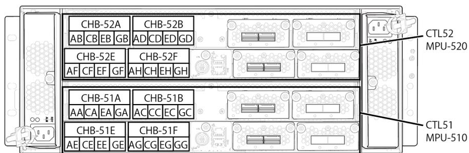
次の図に DKC 後面のチャンネルボード、ディスクボードおよび相互接続チャンネルボードのロケーションを示します。
