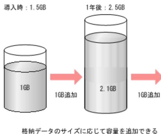
図中の固定サイズのボリューム使用時で Dynamic Provisioning for Mainframe を使用しない場合の例では、導入時に無駄な領域が多く、ボリュームの容量を確保するための費用が多くかかっていました。この理由は、ボリュームを定義するときはその容量のボリュームを準備しておく必要があるからです。また、この例では、1年後にボリュームの容量が 80%を超えたため、その後のボリューム使用量増加に対応したシステムの再構築が必要となります。
