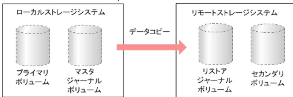
Dynamic Provisioning for Mainframe、Dynamic Tiering for Mainframe、または active flash for mainframe と Universal Replicator for Mainframe とを併用した場合、仮想ボリュームをコピーできます。
