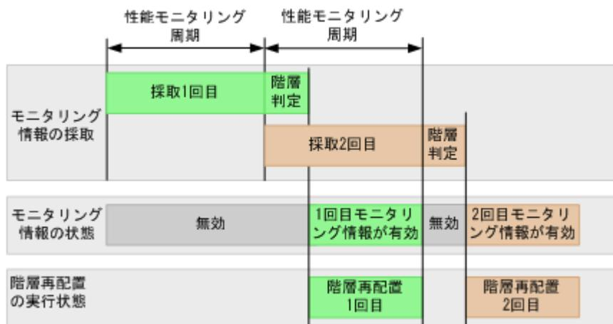
自動実行モードの場合、階層再配置の実行と並行して次の実行周期のモニタリング情報の採取が実
