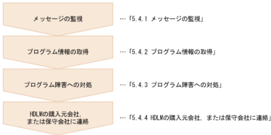
図 5-3 プログラム障害時の対処手順
