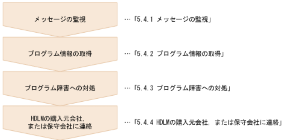
図 5-3 プログラム障害時の対処手順
