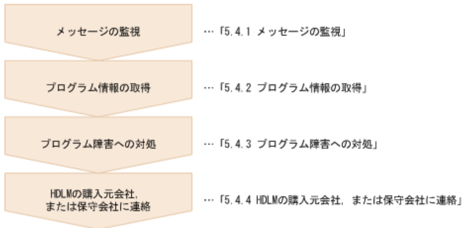
図 5-3 プログラム障害時の対処手順
