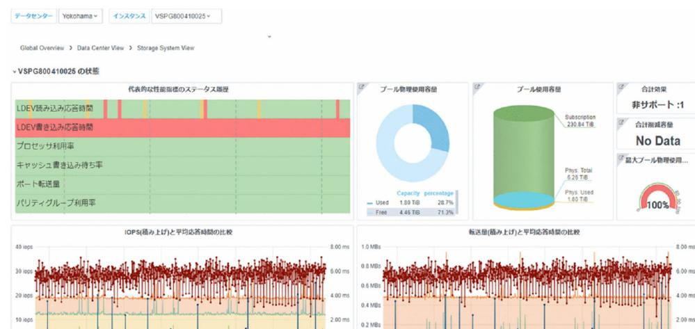
5. 代表的な性能指標のステータス履歴から LDEV 書き込み応答時間が危険を示していた情報を確認します。
