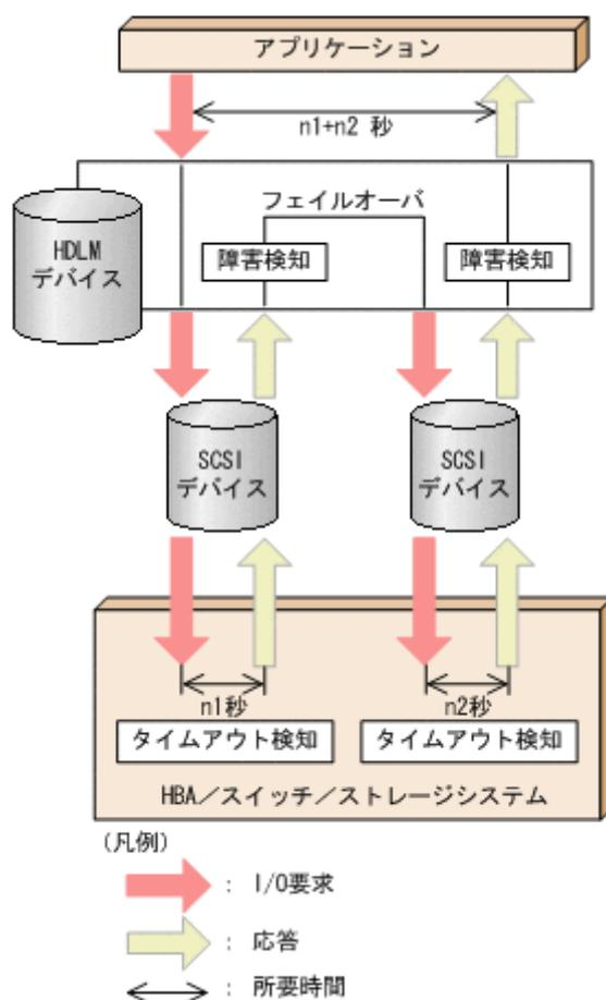
図に示すように、HDLM デバイスに対応するパス (SCSI デバイス) が 2 つある場合、アプリケーションが I/O 要求を発行してから応答が返るまでの時間は、最大で SCSI デバイス A を使用するパスのタイムアウト値 ( $n1$  秒) と、SCSI デバイス B を使用するパスのタイムアウト値 ( $n2$  秒) の合計値 ( $n1+n2$  秒) になります。
