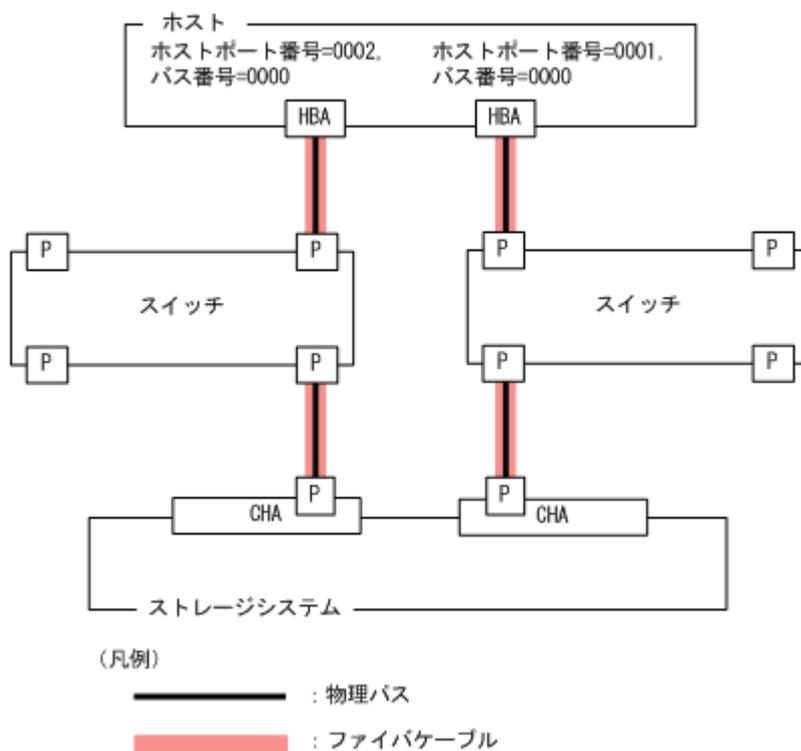
1. 交換するファイバチャネルスイッチを経由するパス（ファイバチャネルスイッチが接続している HBA を経由するパス）を Offline(C)状態にします。
