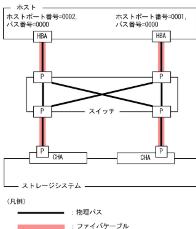
1. 交換するファイバケーブルを経由するパス（ファイバケーブルが接続している HBA を経由するパス）を Offline(C)状態にします。
