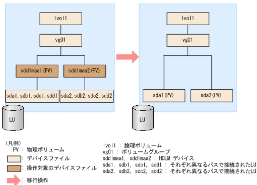
「[図 3-22 HDLM デバイス上にある論理ボリュームを SCSI デバイス上に移行する場合のデバイス構成](#)」の sda1, sdb1, sdc1, sdd1 は同じ LU を示します。また、sda2, sdb2, sdc2, sdd2 も同じ LU を示します。sddlmaa1 と sddlmaa2 はそれぞれの LU に対応する HDLM デバイスを示します。
