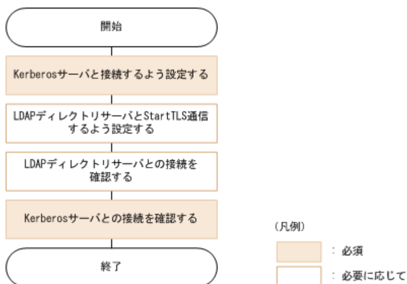
図 1-5 Kerberos サーバと連携する作業フロー
