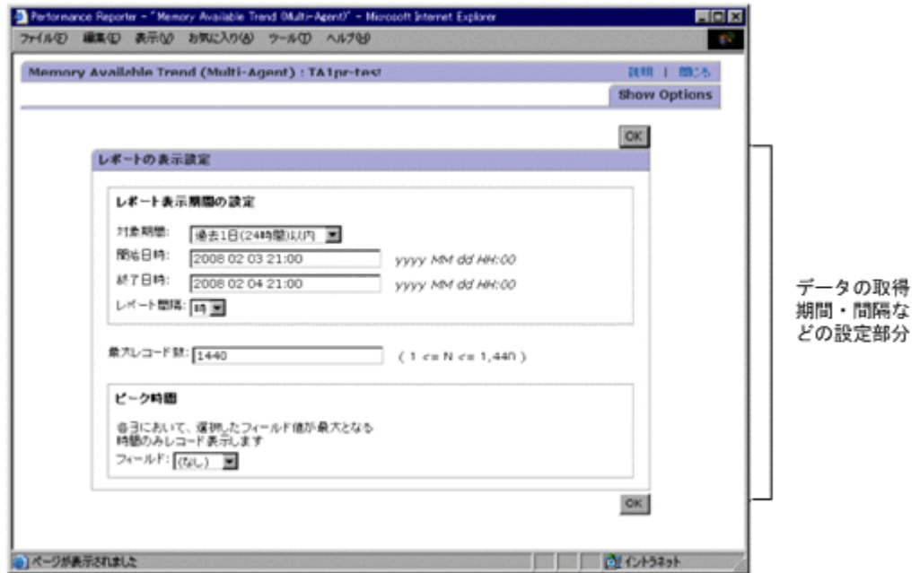
図 7-26 レポート表示時にデータの取得期間・取得間隔を設定する場合
