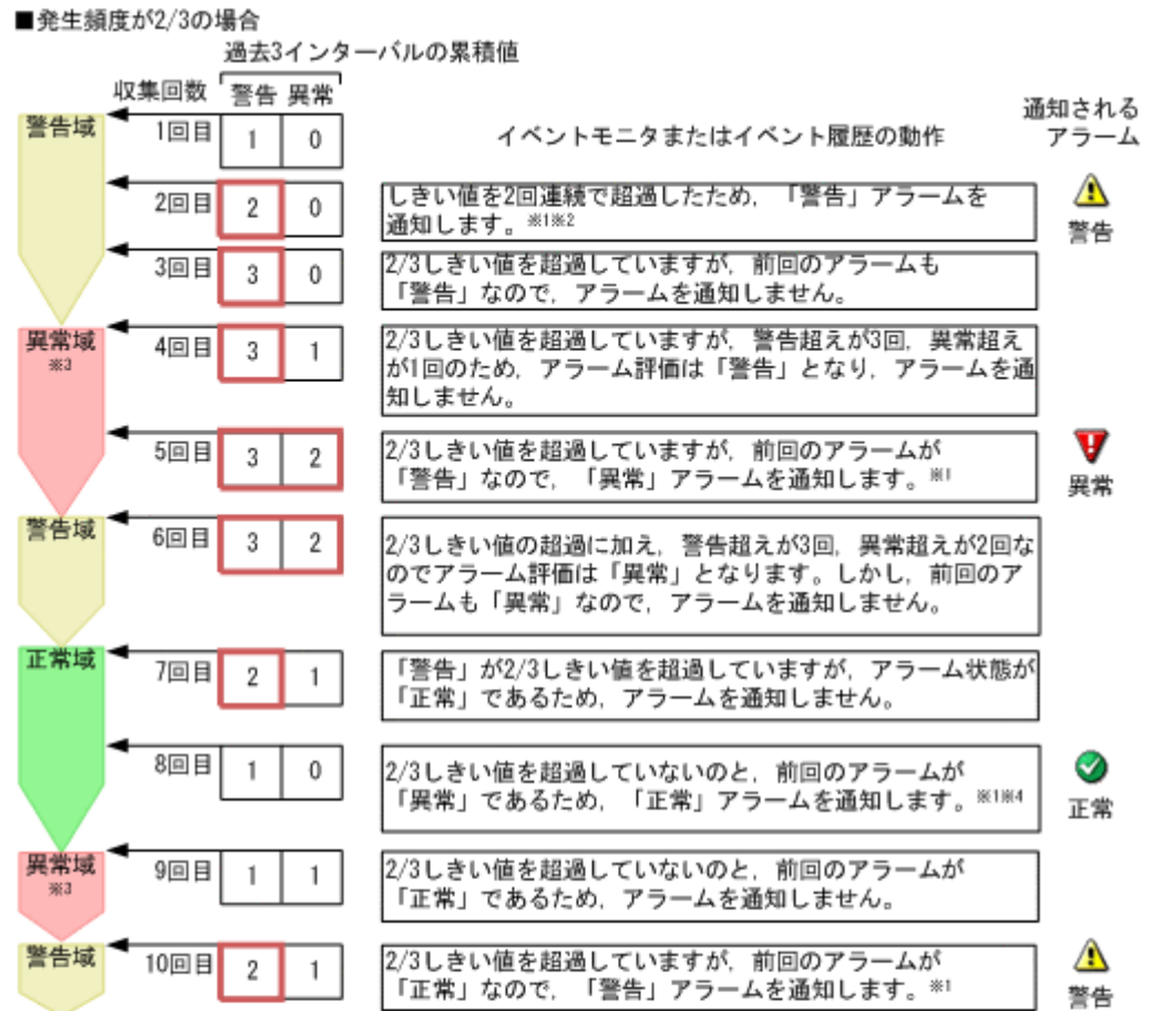
図 9-21 [常に] にチェックなし [すべての] にチェックなしの場合のアラームイベント
